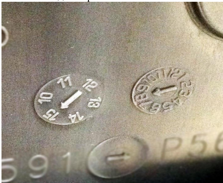
Год и месяц выпуска, выштампованы на пластике.
