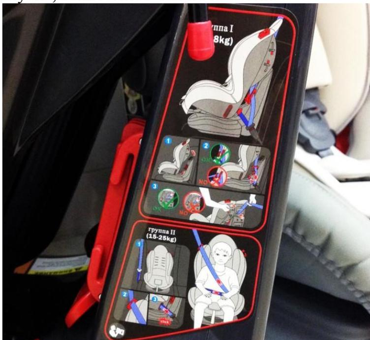
Схема пристегивания с помощью ремня безопасности для взрослых
